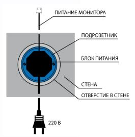
**Примечание:** укорачивание провода питания монитора или обрезание вилки 220В не снимает блок питания с гарантии, если при монтаже были соблюдены правила соединения и изоляции проводов, а также полярности подключения.
